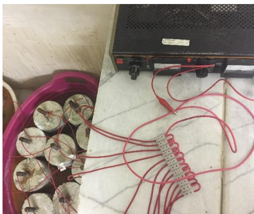
شکل ۱- آزمون ها و مجموعه تجهیزات آزمایش خوردگی تسریع یافته
