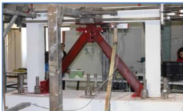
شکل ۷: جزئیات قاب بتن آرمه و پیکربندی آزمایشگاهی [۲۰].
