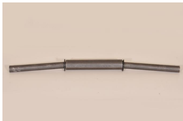
شکل ۱۳: سیستم لوله در لوله - نمونه ۴ بعد از انجام آزمایش.
