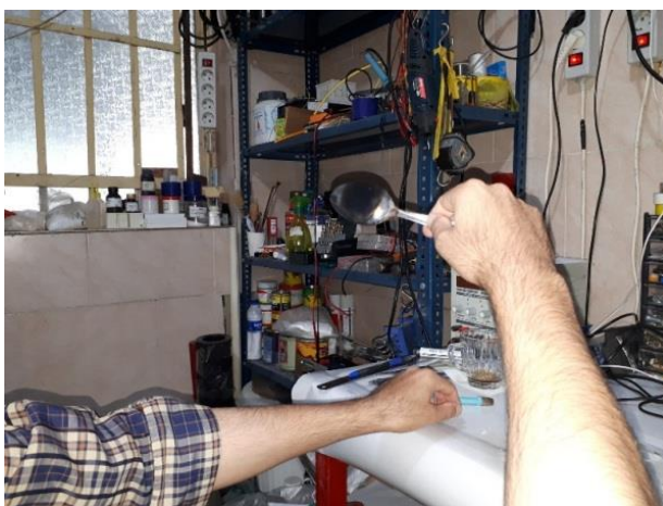
شکل ۴: تهیه ماده آلوده کننده دوده برای آزمایش بر روی رنگ سطح بتن.
