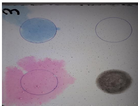
شکل ۱۱: سطح نمونه بتنی آغشته شده با ماده آلوده کننده دوده (مشکی)، رودامین B (صورتی) و متیلن (آبی) برای آزمایش بر روی رنگ سطح بتن نمونه با ۵ درصد دی اکسید تیتانیوم در شروع آزمایش.
