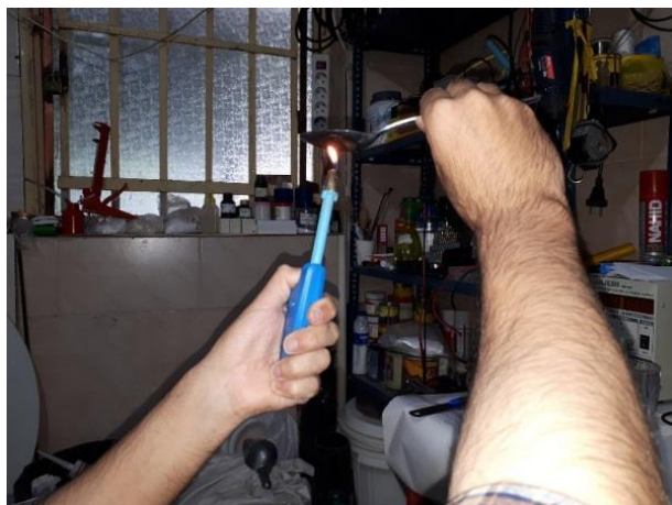
شکل ۳: تهیه ماده آلوده کننده دوده برای آزمایش بر روی رنگ سطح بتن
