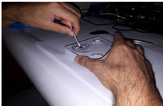
شکل ۶: پاشیدن ماده آلوده کننده دوده برای آزمایش بر روی رنگ سطح بتن نمونه.
