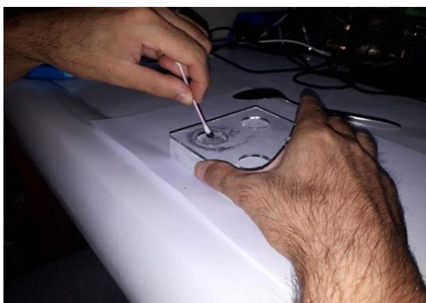
شکل ۵: پاشیدن ماده آلوده کننده دوده برای آزمایش بر روی رنگ سطح بتن نمونه.
