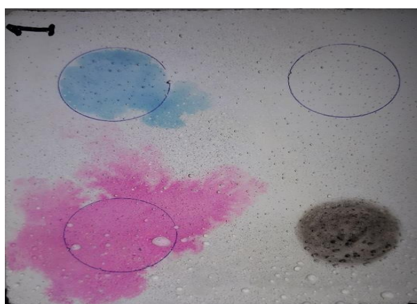
شکل ۸: سطح نمونه بتنی آغشته شده با ماده آلوده کننده دوده (مشکی)، رودامین B (صورتی) و متیلن (آبی) برای آزمایش بر روی رنگ سطح بتن نمونه با گذشت زمان ۲۴ ساعت بدون افزودن دی اکسید تیتانیوم و ۳ درصد نانوسیلیس.
