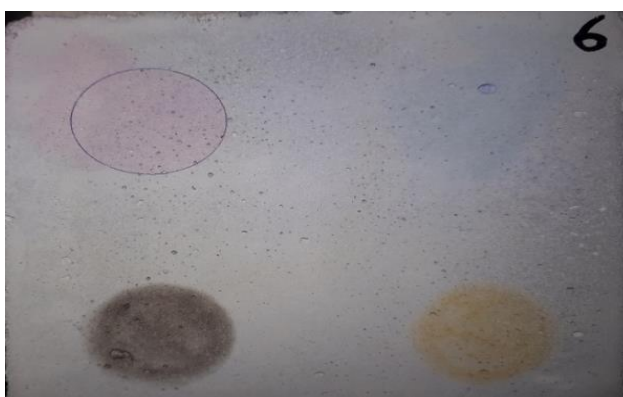
شکل ۱۹: مقایسه سطح نمونه بتنی آغشته شده با ماده آلوده کننده دوده (مشکی)، با ماده آلوده کننده رودامین B (صورتی) و متیلن (آبی) برای آزمایش بر روی رنگ سطح بتن نمونه با ۵ درصد دی اکسید تیتانیوم در طرح ۳ حاوی نانوسیلیس و طرح ۶ حاوی سیلیکافیوم بعد از گذشت زمان ۲۴ ساعت.
