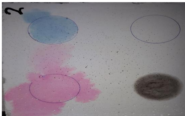
شکل ۹: سطح نمونه بتنی آغشته شده با ماده آلوده کننده دوده (مشکی)، رودامین B (صورتی) و متیلن (آبی) برای آزمایش بر روی رنگ سطح بتن نمونه با ۲/۵ درصد دی اکسید تیتانیوم در شروع آزمایش.
