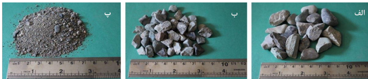
شکل ۱: سنگدانه های طبیعی؛ الف) شن بادامی ب) شن نخودی پ) ماسه
