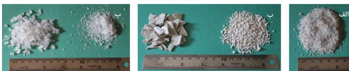
شکل ۲: سنگدانه های پلاستیکی؛ الف) PET ب) HIPS پ) PP
