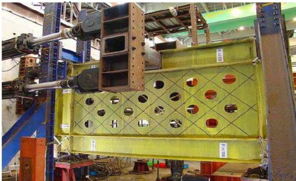
شکل ۸ نمونه P قبل از آزمایش، ویان و برونو، ۲۰۰۹
