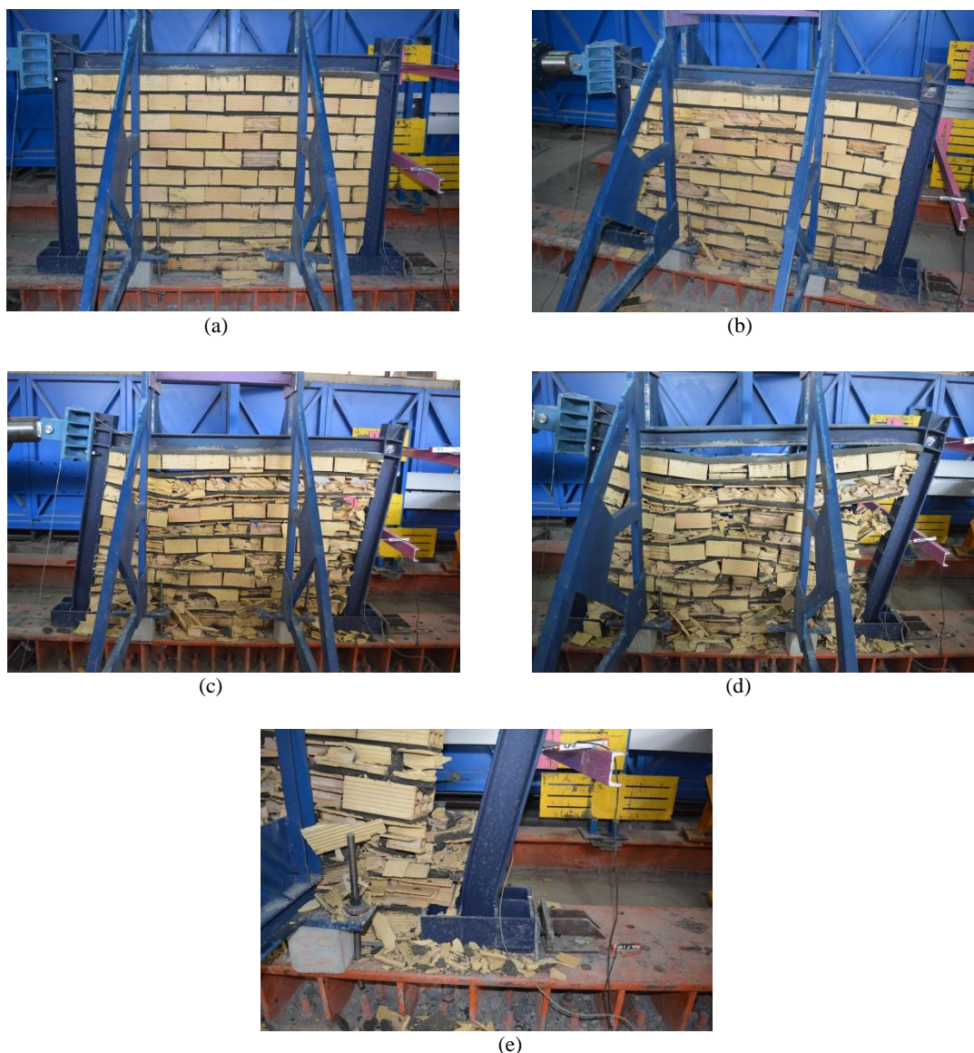
شکل ۸: نمونه SW3 در مراحل مختلف بارگذاری (a) دررفت ۱٪ (b) دررفت ۵٪ (c) دررفت ۱۰٪ (d) دررفت ۱۵٪ (e) کمانش بال ستون
