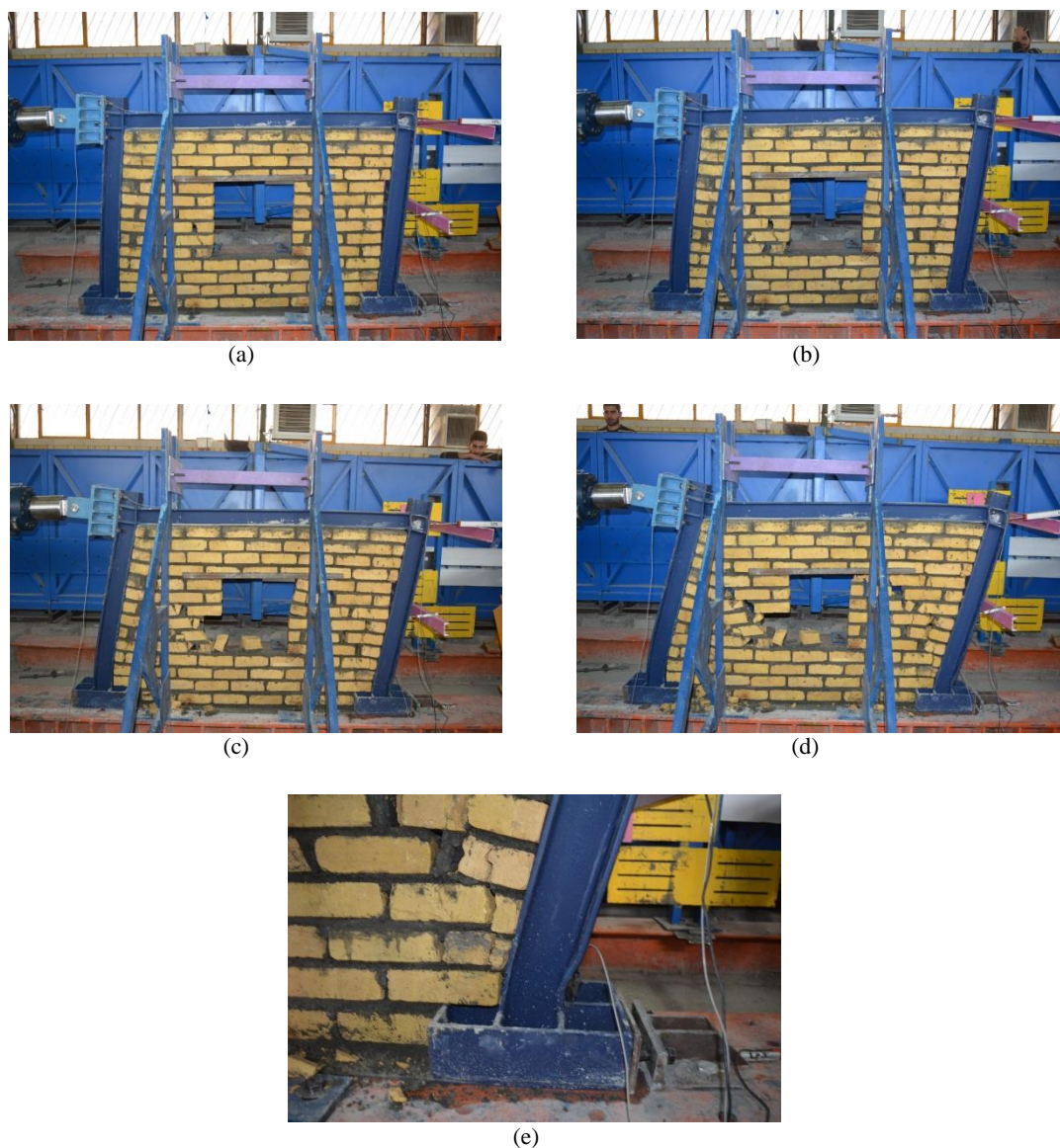
شکل ۱۰: نمونه PW در مراحل مختلف بارگذاری (a) دریفت ۱٪ (b) دریفت ۵٪ (c) دریفت ۱۰٪ (d) دریفت ۱۵٪ (e) کماتش ستون.
