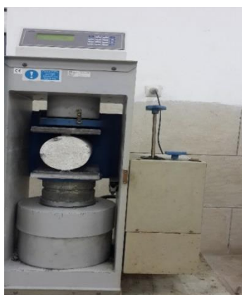
شکل ۱۰: آزمایش مقاومت فشاری و کششی و بتن شکسته شده بعد از مقاومت کششی به ترتیب از چپ به راست
