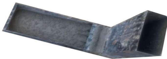
شکل ۶: بتن خودتراکم در حال عبور در جعبه L
