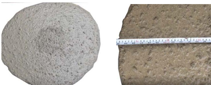
شکل ۴: قطر جریان بازشدگی و محاسبه آن
