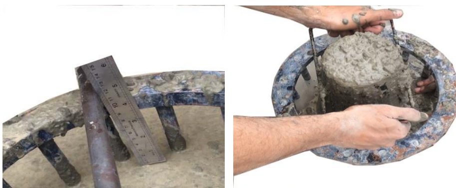
شکل ۸: نحوه انجام آزمایش حلقه J
