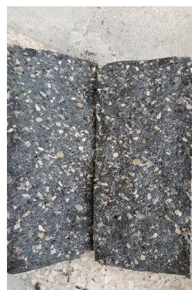
شکل ۱۰: آزمایش مقاومت فشاری و کششی و بتن شکسته شده بعد از مقاومت کششی به ترتیب از چپ به راست
