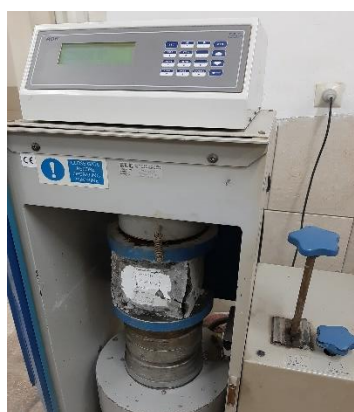
شکل ۱۰: آزمایش مقاومت فشاری و کششی و بتن شکسته شده بعد از مقاومت کششی به ترتیب از چپ به راست
