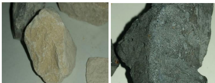
شکل ۱: شکل ظاهری و بافت سطحی سنگدانه های درشت طبیعی و سرباره فولادی به ترتیب از چپ به راست
