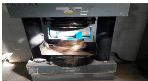
شکل ۸: گسیختگی بتن در آزمایش کشش برزیلی
