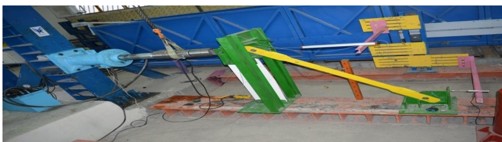
شکل ۱۱: نمایی از هسته بادبند کمانش ناپذیر و LVDT های نصب شده.
