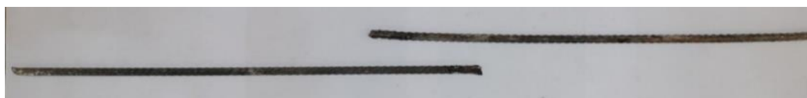
شکل ۷: نمونه میلگرد ۱۰ با وصله پوششی با جوش منقطع کناری در حالت a=1d بعد از انجام آزمایش کشش
