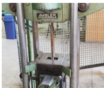
شکل ۲: نمونه با وصله پوششی با جوش منقطع کناری در حالت a=5d در حال انجام آزمایش کشش
