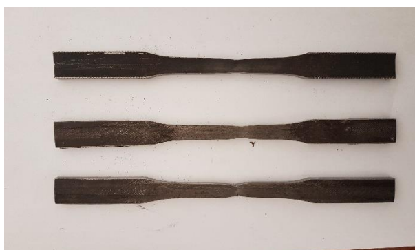
شکل ۶: نمونه‌های کششی تست شده
