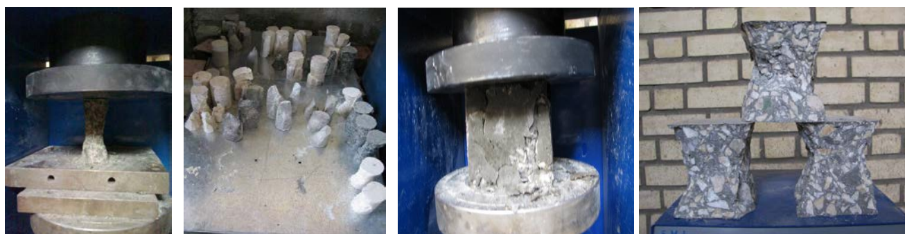
شکل ۱: انجام آزمایش مقاومت فشاری تک‌محوره برای مغزه‌های سنگی و مکعب بتنی.
