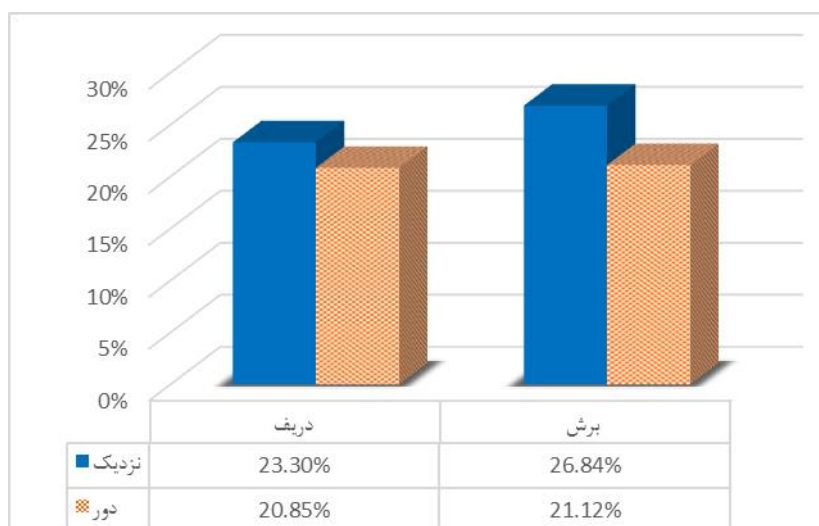
شکل ۲۸- مقایسه میانگین کلی درصد کاهش تغییر مکان نسبی سازه و برش در حالت با میراگر نسبت به بدون میراگر تحت زلزله دور و نزدیک گسل
