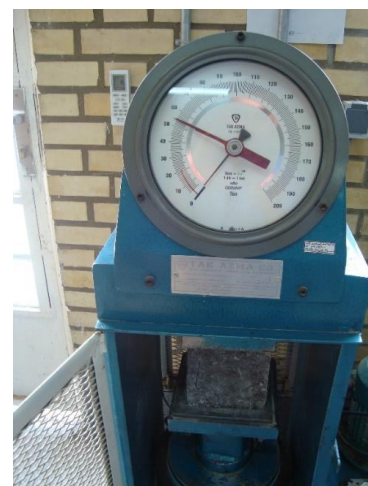
تصویر ۳: نمایی از انجام آزمایش‌های مقاومت فشاری، مقاومت کششی دونیم‌شدن و تعیین سرعت انتشار امواج فراصوت
