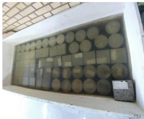
تصویر ۲: برخی از نمونه‌های ساخته شده و شرایط عمل‌آوری و نگهداری آن‌ها
