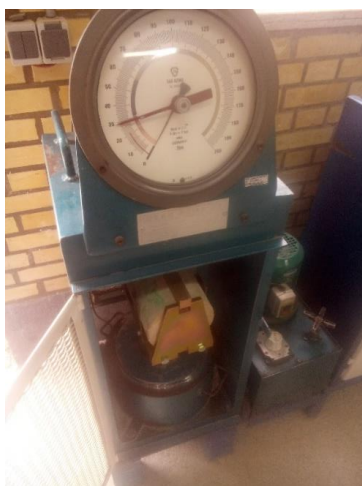
تصویر ۳: نمایی از انجام آزمایش‌های مقاومت فشاری، مقاومت کششی دونیم‌شدن و تعیین سرعت انتشار امواج فراصوت
