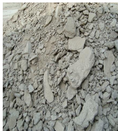
تصویر ۱: دپوی سنگدانه‌های بازیافتی استفاده شده در تحقیق و جداسازی آن‌ها
