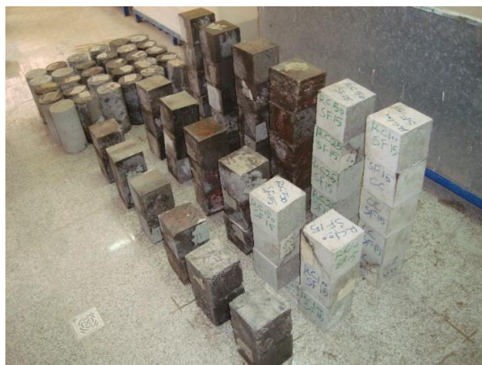
تصویر ۲: برخی از نمونه‌های ساخته شده و شرایط عمل‌آوری و نگهداری آن‌ها
