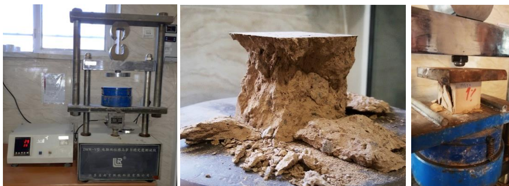
شکل ۸: تصویر جک مکانیکی ملات شکن
