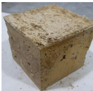
شکل ۱۳: نمونه خشت تثبیت شده عیش آباد
