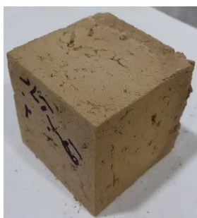
شکل ۱۱: نمونه خشت تثبیت شده قطب‌آباد
