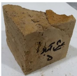
شکل ۱۴: نمونه خشت تثبیت شده عیش آباد
