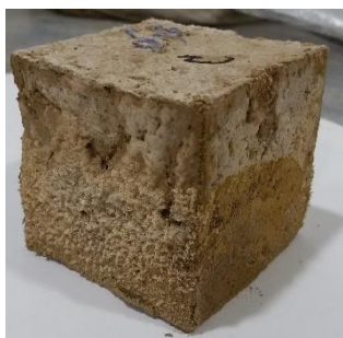
شکل ۲۳: نمونه خشت تثبیت شده
