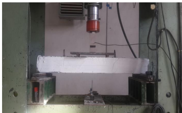
شکل ۹: دستگاه بارگذاری و نحوه‌ی بارگذاری نمونه‌ها
