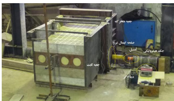
شکل ۵- مدل شماتیک تجهیزات آزمایش و نحوه قرارگیری جعبه‌ها در قاب صلب (آزمایشگاه سازه-دانشگاه شهید رجایی)
