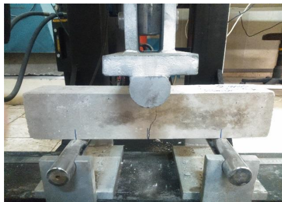
شکل (۳) شکستن تیر توسط دستگاه خمش
