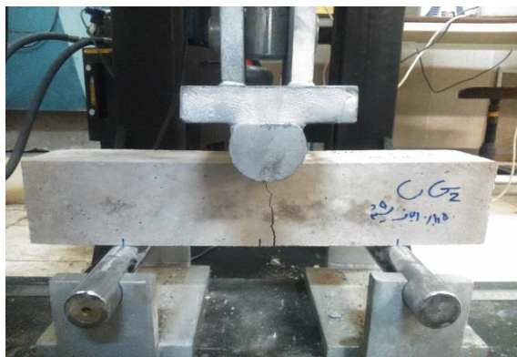
شکل (۳) شکستن تیر توسط دستگاه خمش
