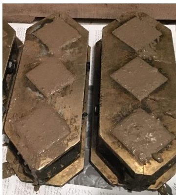
شکل ۲: نمونه‌های ساخته شده از ملات ژئوپلیمری با پایه سرباره کوره‌های آهن‌گدازی
