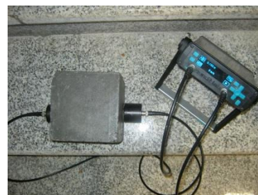
شکل ۱۵- الف: نمایی کل از نحوه انجام آزمایش شکل ۱۵- ب: نتایج آزمایش فراصوتی برای انواع طرح اختلاط شکل ۱۵: نتایج آزمایش فراصوتی در دو سن ۲۸ و ۹۰ روزه
