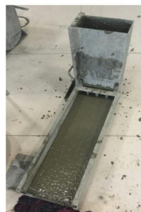
شکل ۷- الف: نحوه انجام آزمایش جعبه L شکل ۷- ب: نتایج آزمایش جعبه L برای انواع طرح اختلاط های مورد استفاده شکل ۷: آزمایش جعبه L شکل با طرح اختلاط صحیح
