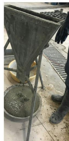
شکل ۶- الف: نحوه انجام آزمایش قیف V شکل ۶- ب: نتایج آزمایش قیف V برای انواع طرح اختلاط های مورد استفاده شکل ۶: بررسی آزمایش قیف V برای انواع طرح اختلاط های مورد استفاده
