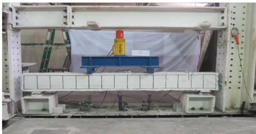
شکل ۷: نحوه بارگذاری تیرهای بتنی معمولی و HPFRCC آزمایش شده توسط همتی و همکاران [2]
