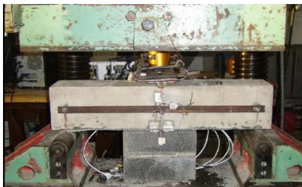
شکل ۲: تنظیمات آزمایشگاهی برای بارگذاری و ثبت اطلاعات نمونه‌ها [۱۹].
