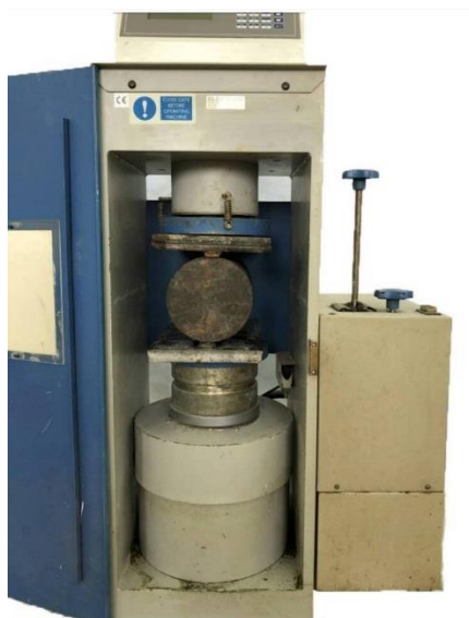
شکل ۴: آزمایش مقاومت کششی
