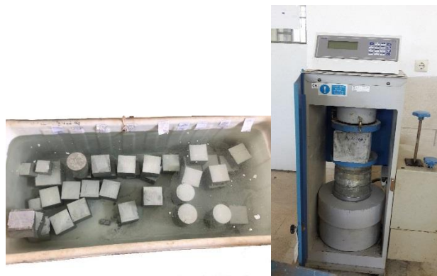
شکل ۳: عمل‌آوری نمونه‌ها و آزمایش مقاومت فشاری
