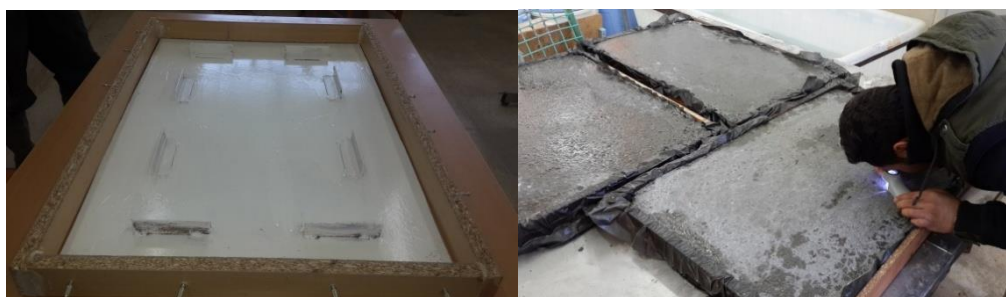
شکل ۵: قالب دال و چگونگی اندازه‌گیری عرض ترک
