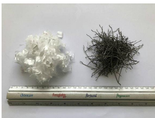
شکل ۱: نمونه الیاف پلی پروپیلین و فولادی قلاب دار
