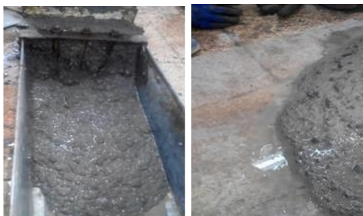
شکل ۱۰: بتن در معرض آب انداختگی حاوی ۰/۰۸ درصد وزن آب VMA
