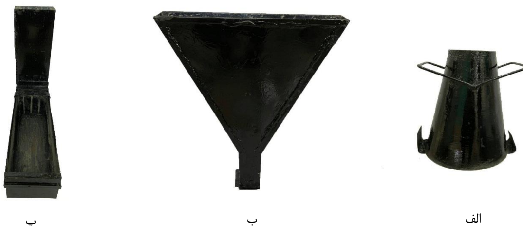
شکل ۲: الف- آزمایش جریان اسلامپ؛ ب- آزمایش قیف V؛ پ- آزمایش جعبه‌ای L
