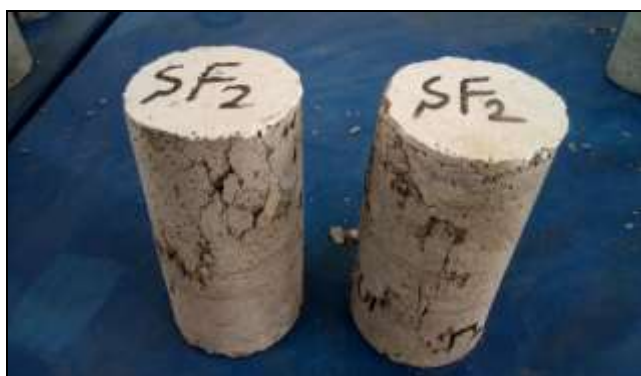
ب: شکست نمونه ها پس از تست مقاومت فشاری
