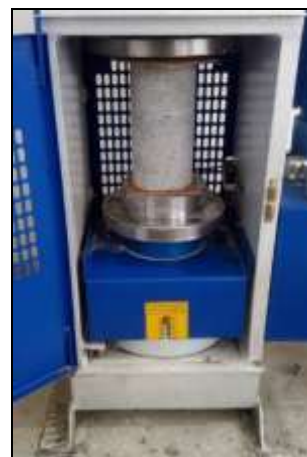
الف: نحوه ی قرارگیری نمونه در زیر جک
