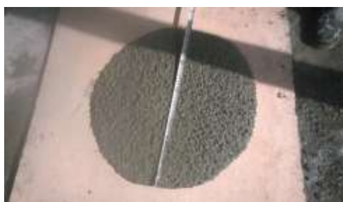
شکل ۱: آزمون جریان اسلامپ و T50 برای برخی بتن های ساخته شده
