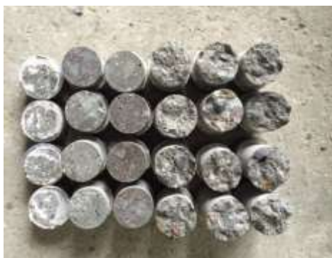
شکل ۲: نحوه شکست نمونه ها: از چسب، از مرز و از بتن بستر
