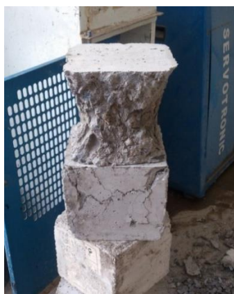
شکل ۲: حالت رضایت بخش گسیختگی نمونه های مورد آزمایش
