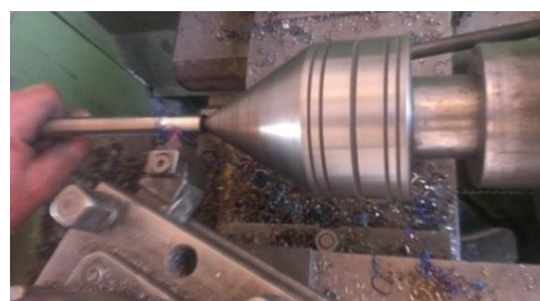
شکل ۷: تراشکاری جهت رزوه نمودن SMA
