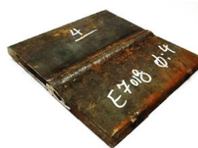
شکل ۳: قطعه جوشکاری شده
