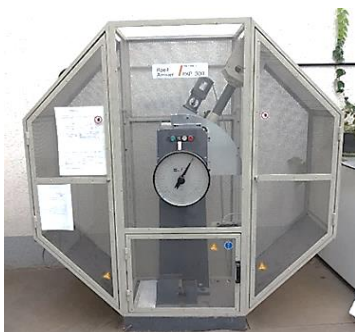
شکل ۱۰: دستگاه تست ضربه (شارپی)
