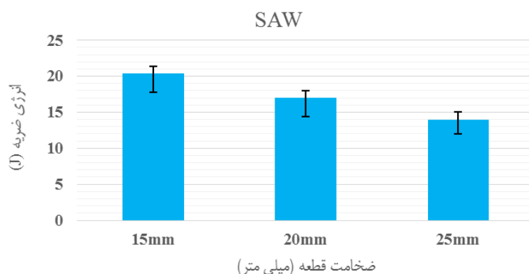
شکل ۱۴: میانگین نتایج تست ضربه الکتروود زیرپودری SAW
