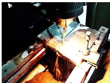
شکل ۶: برش نمونه در دستگاه وایرکات
