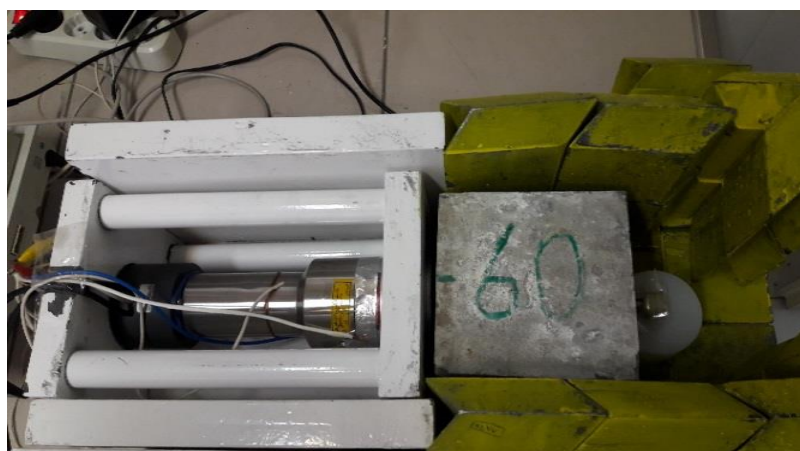
شکل ۴: قرار گرفتن آشکارساز پشت نمونه و دریافت اشعه ی گامای عبور کرده از بتن
