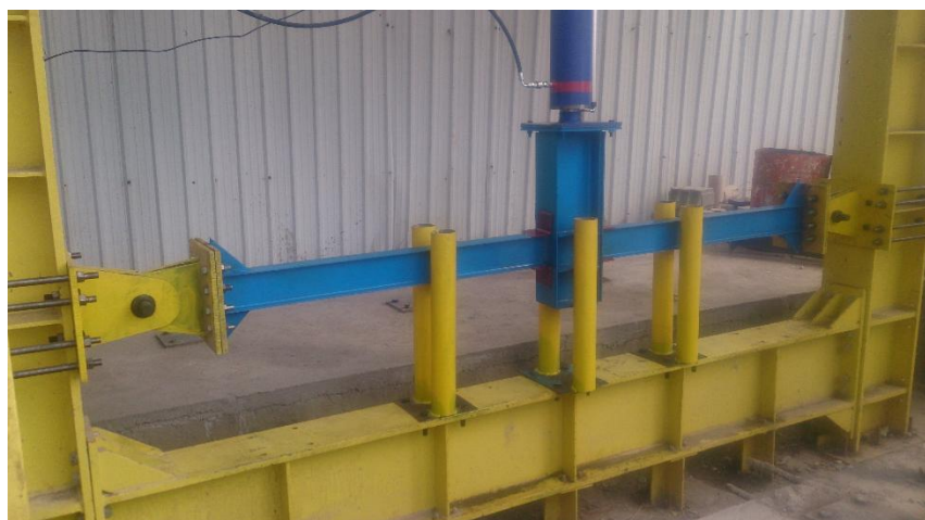
شکل ۶: نمای کلی از نمونه اتصال جوشی آزمایش شده در دانشگاه صنعتی شیراز
