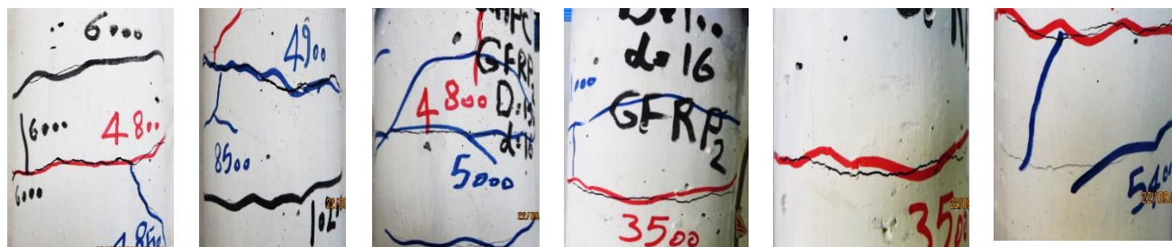
شکل ۹: ب: بازشدگی ترک‌ها برای نمونه 150-16-GFRP2
