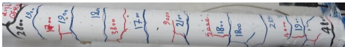
الف- ترک خوردگی در نمونه مورد آزمایش
