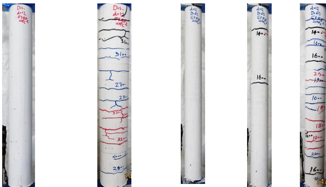
شکل ۴: الف: مراحل پیدایش ترک برای نمونه 65-12-GFRP2 میان بارگذاری شکل ۴: ب: مراحل پیدایش ترک برای نمونه 100-12-GFRP2 پایان بارگذاری
