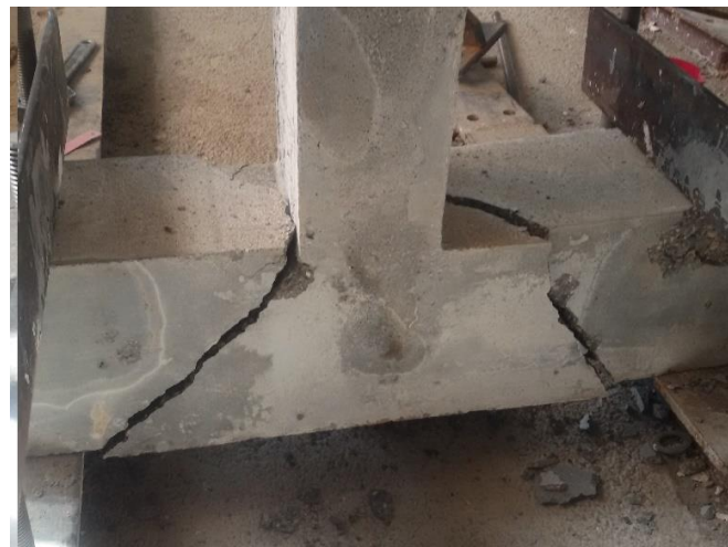
شکل ۷: حالت شکست پیچشی بتن شاهد
