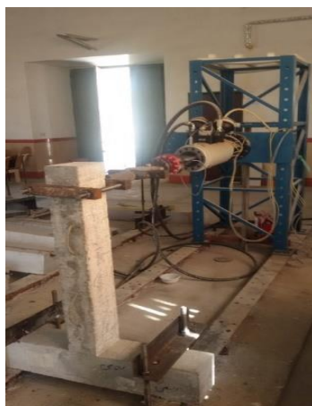
شکل ۳: اتصال نمونه به دستگاه و کف صلب
