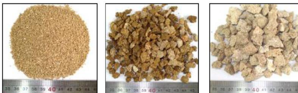
شکل ۱: نمونه‌های خرد شده لوماشل توسط سنگ شکن
