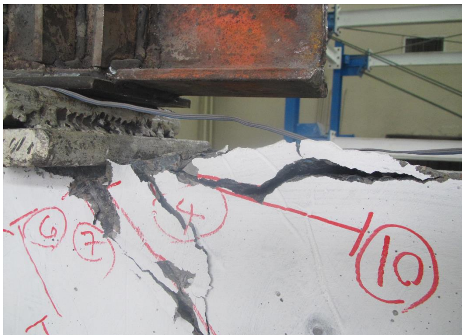
شکل ۱۰: نحوه ترک خوردگی و شکست تیر B-R
