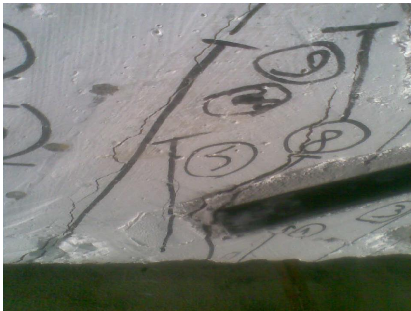
شکل ۸: نحوه ترک خوردگی و شکست تیر A-E
