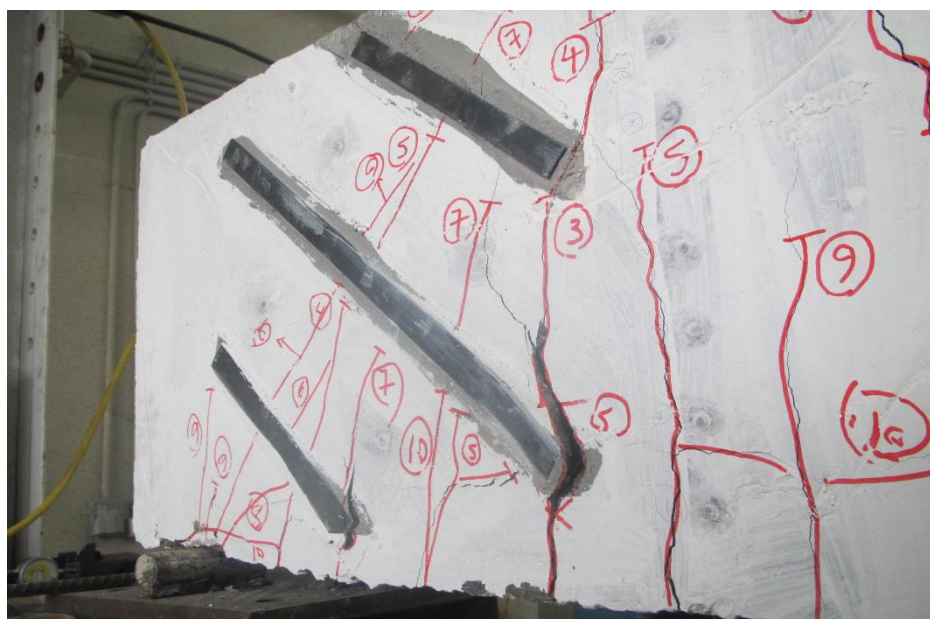
شکل ۱۱: نحوه ترک خوردگی و شکست تیر B-E
