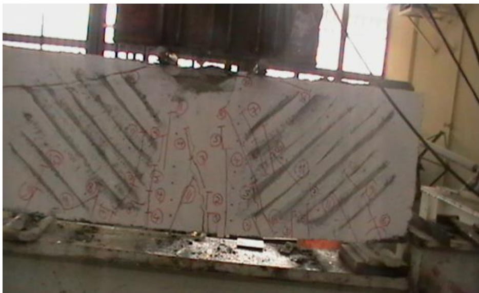
شکل ۹: نحوه ترک خوردگی و شکست تیر A-N
