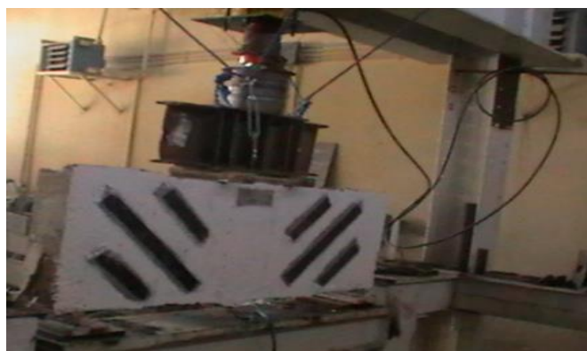
شکل ۵. نمونه‌ای از سیستم بارگذاری تیر
