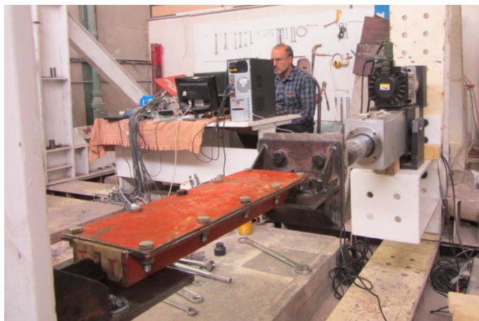
شکل ۲: نمونه مهاربند کمانش ناپذیر ساخته شده در آزمایشگاه
