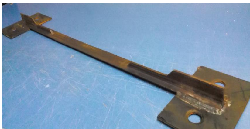
شکل ۳: هسته سپری شکل به همراه ورق های اتصال
