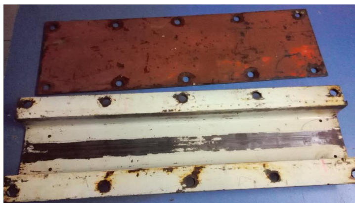
شکل ۶: غلاف فولادی ناودانی نمره ۱۰ و ورق ۱۰ میلی متری
