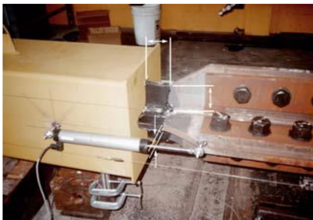
شکل ۱: نمایش قسمت محصور شده و محصور نشده ی هسته ی فولادی [۹]
