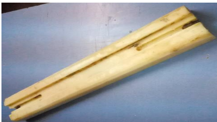
شکل ۵: غلاف پرکننده ی پلی آمید ماشین‌کاری شده
