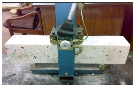
شکل ۱۲: نمایی از تیر خمشی خورده شده حاوی ۲۰ درصد خرده شیشه قرار گرفته در دستگاه آزمایش خمشی
