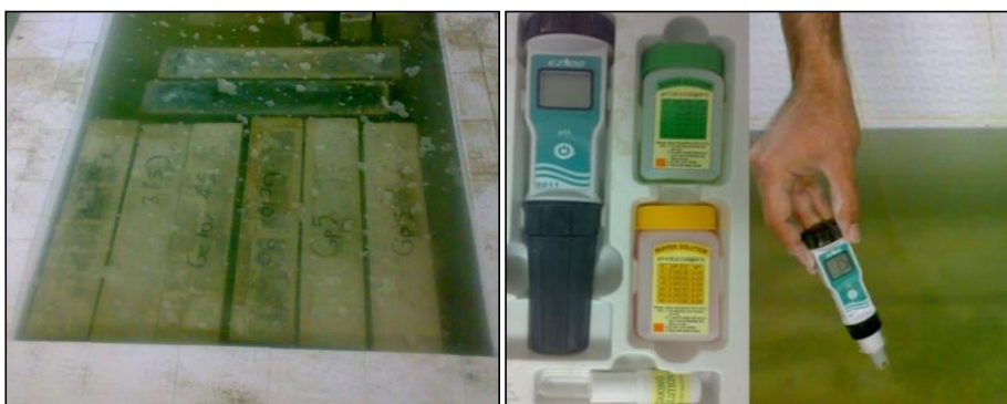
شکل ۳: نمایی از آزمون‌های قرار گرفته در حوضچه اسید و نحوه اندازه‌گیری PH محیط اسیدی توسط PH متر
