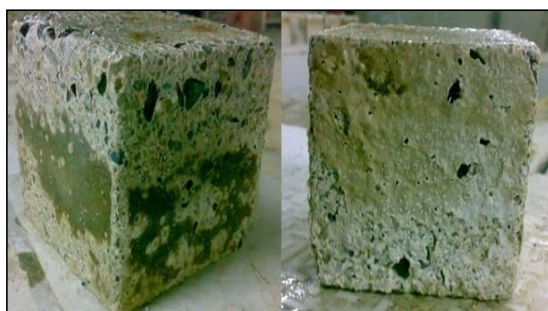
شکل ۱۵: نمایی از نمونه‌ی مکعبی خارج شده از اسید سولفوریک قبل و بعد از پاکسازی رسوبات پس از ۶۰ روز خوردگی
