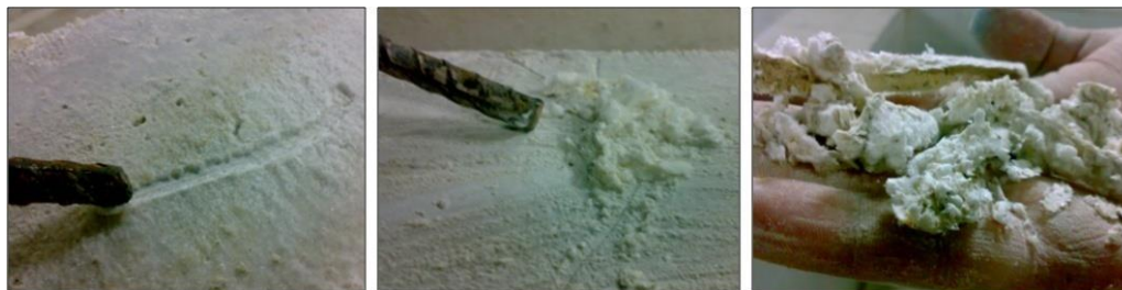
شکل ۱۱: نمایی از گچ تولید شده بر روی نمونه‌ها در اثر خوردگی
