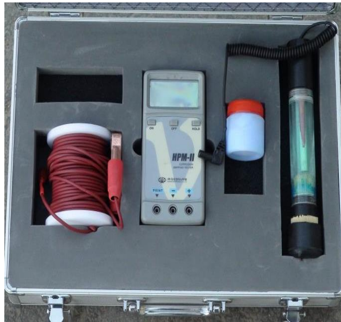
شکل ۳: نیم پیل مورد برای اندازه‌گیری پتانسیل خوردگی.
