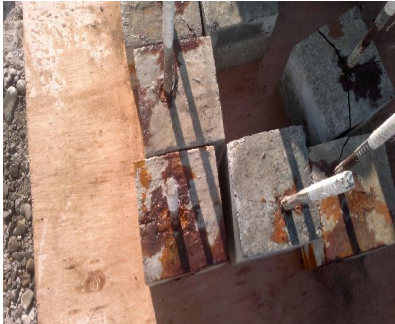
شکل ۱۰: نمونه بتن پس از آزمایش تسریع شده.
