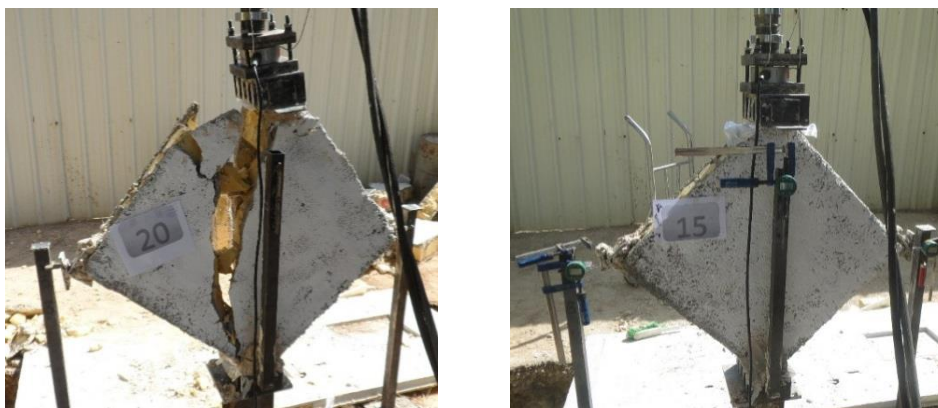
شکل ۶ - سیستم انجام آزمایش قطری نمونه های آجرکار [۱۰]
