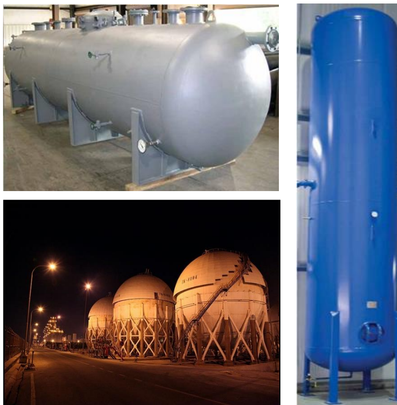
شکل ۱: نمونه دو مخزن تحت فشار استوانه‌ای افقی، عمودی و کروی.
