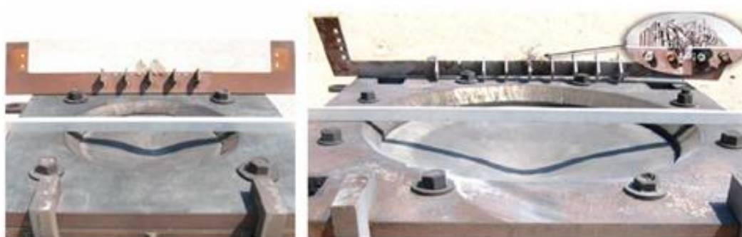
شکل ۷: ایجاد تغییر شکل‌های پلاستیک ورق با قطر ۰/۵ متر (چپ) و قطر ۱ متر (راست) در کار آزمایشگاهی [۱۳].
