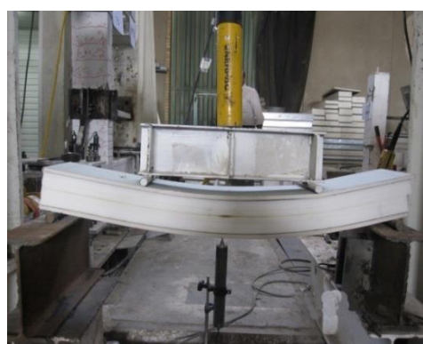
شکل ۲: نحوه بارگذاری و مراحل شکست پانل ها.
