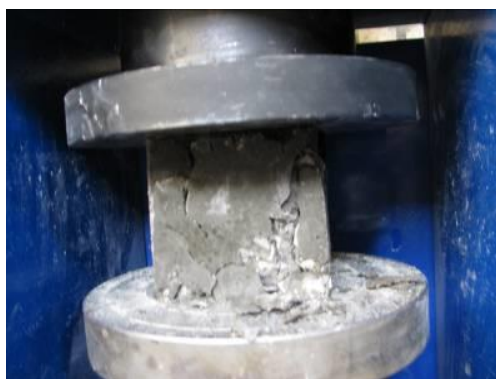
شکل ۴: شکست مکعب بتنی ساخته شده از سنگ مرمریت زیر جک فشاری.
