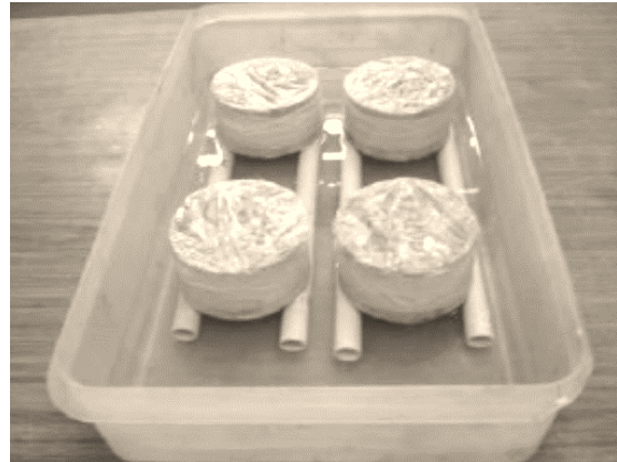
شکل ۲. الف: قرص‌های بتنی تحت آزمایش جذب آب مویینه.
