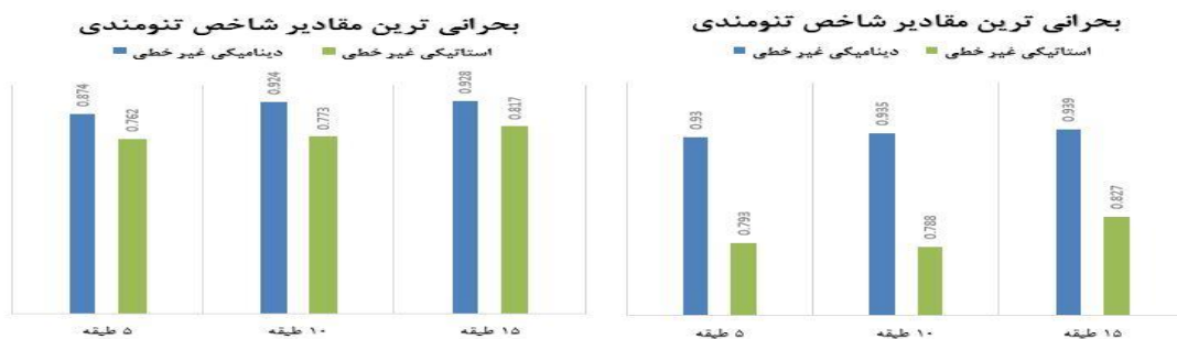
الف ( الف ) شاخص تنومندی حالات حذف ستون کناری و مهاربند های متصل به آن ب ( ب ) شاخص تنومندی حالات حذف ستون کناری شکل ۱۴: مقادیر بحرانی ترین حالت حذف ستون و حذف ستون و مهاربند
