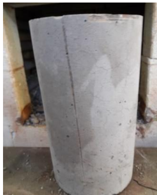
ب- ایجاد ترک های سطحی نمونه ی SF400 در دمای ۵۰۰ درجه
