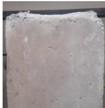
الف: تغییر شکل ظاهری سطح مقطع نمونه ی PPF در دمای بالا
