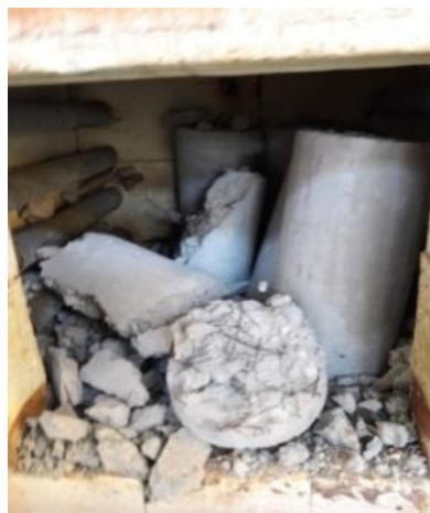
شکل ۴: خرد شدن نمونه SF در دمای ۵۰۰ و ۷۰۰ درجه ی سانتیگراد.
