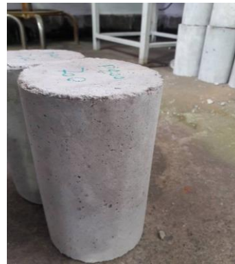
ج- ایجاد ترک های سطحی نمونه ی PPF400 در دمای ۷۰۰ درجه
