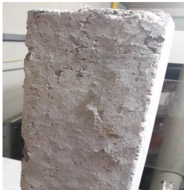
ب: پوسته شدن نمونه در دمای بالا
