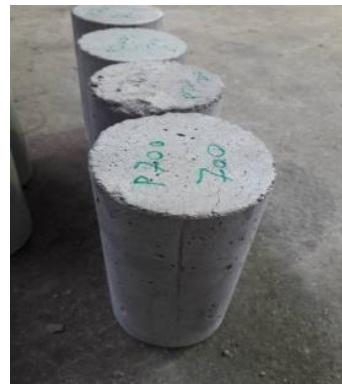
الف- ایجاد ترک های سطحی نمونه ی PPF700 در دمای ۷۰۰ درجه
