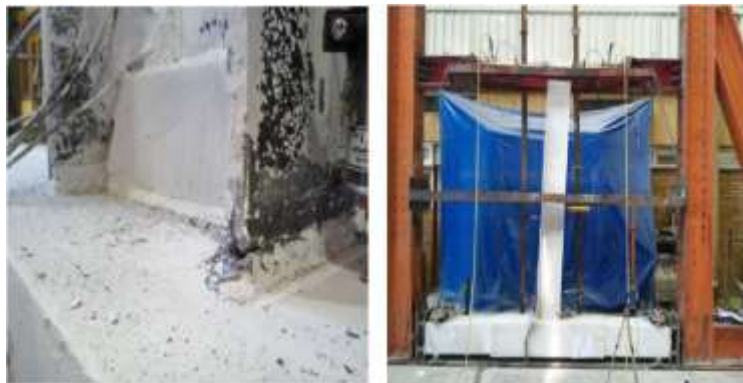
شکل ۴: نمونه اتصال کوچک در دوران ۰/۰۵ رادیان [۱۴].
