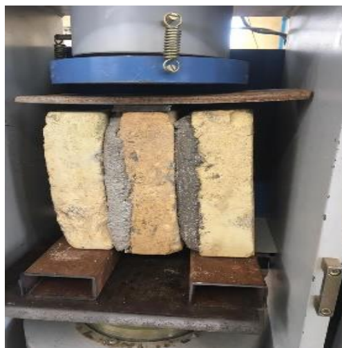
شکل ۵: آزمایش مقاومت برشی محل اتصال.
