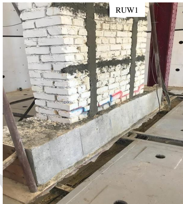
شکل ۱۳: در نسبت جابجایی 0/917\% اولین ترک‌های قابل دیدن.
