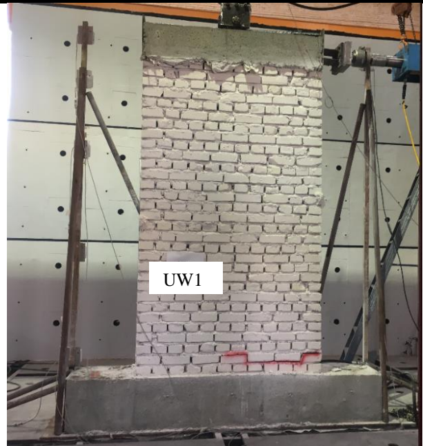
شکل ۱۰: در نسبت جابجایی 0/107\% وقوع ترک‌های اولیه.
