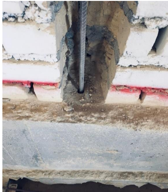
شکل ۲: نحوه کاشت میلگرد در نمونه RUW1.
