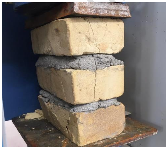
شکل ۶: آزمایش مقاومت فشاری واحد مصالح بنایی.
