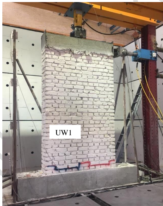
شکل ۱۲: در نسبت جابجایی 0/96\% پایان آزمایش.
