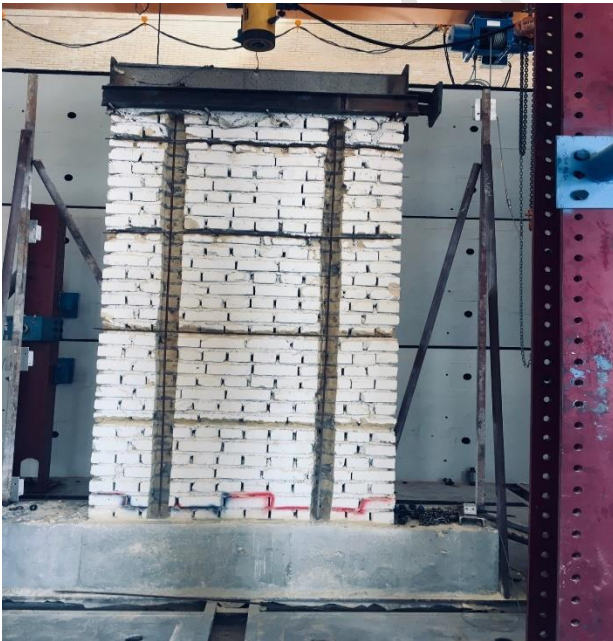
شکل ۲: نحوه کاشت میلگرد در نمونه RUW1.
