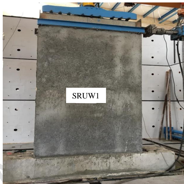
شکل ۱۷: در نسبت جابجایی 0/25\% اولین ترک‌های قابل دیدن.
