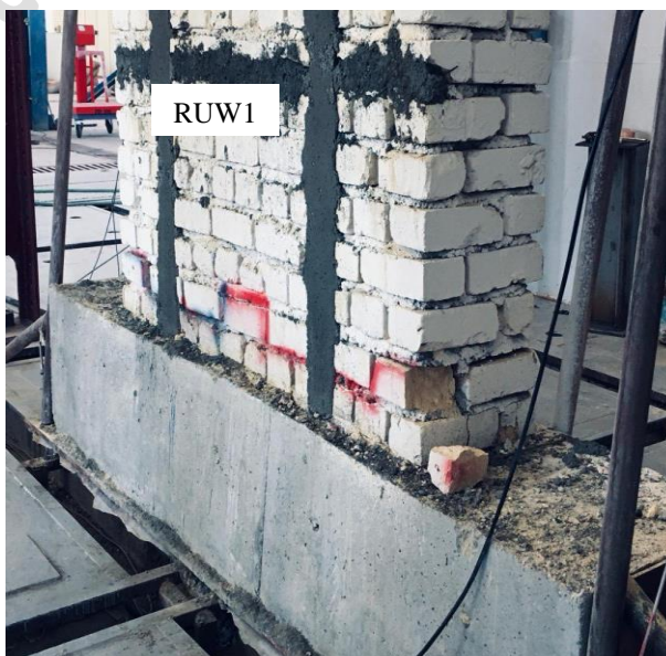
شکل ۱۵: در نسبت جابجایی 0/461\% خرد شدن آجر پاشنه.
