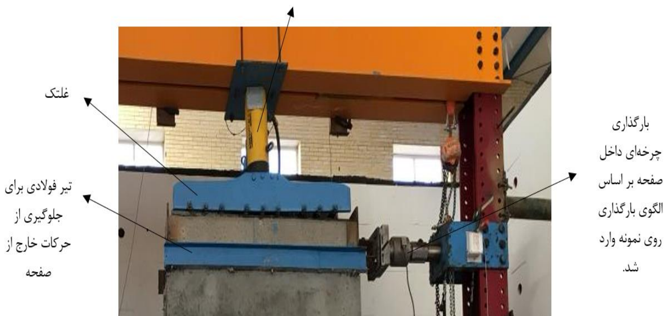
شکل ۸: جزئیات جک‌های افقی و قائم.
