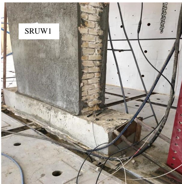
شکل ۱۸: ترک بعدی با ادامه دادن بارگذاری در سمت راست نمونه.
