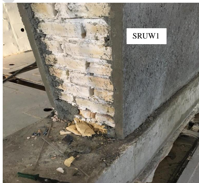
شکل ۱۹: در نسبت جابجایی 0/312\% خرد شدن آجر پاشنه.
