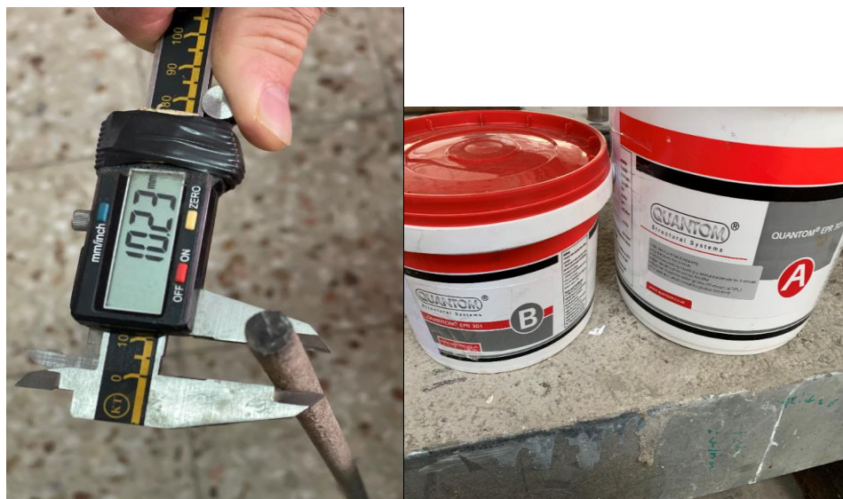
شکل ۳: میلگردهای GFRP و چسب مورد استفاده در روش تقویت NSM
