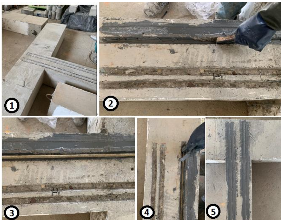
شکل ۷: نحوه تقویت نمونه ها به روش NSM
