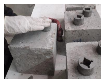
الف: چسباندن استوانه فولادی
