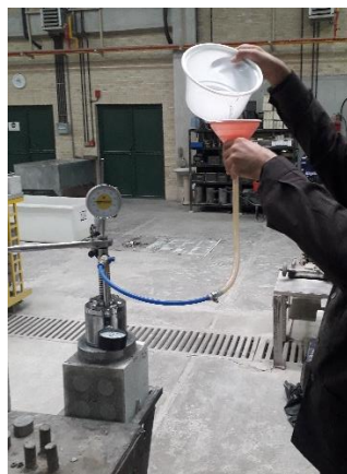
ب: پر کردن دستگاه با آب
