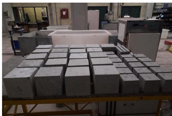
ب: نمونه‌های قرار داده شده در فضای آزاد
