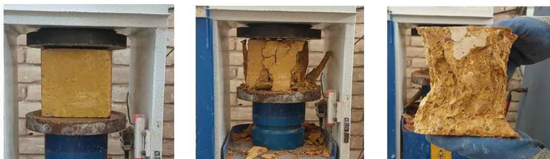
شکل ۱۰ سنجش مقاومت فشاری نمونه‌های بتن مکه‌بی دارای لیمونیت
