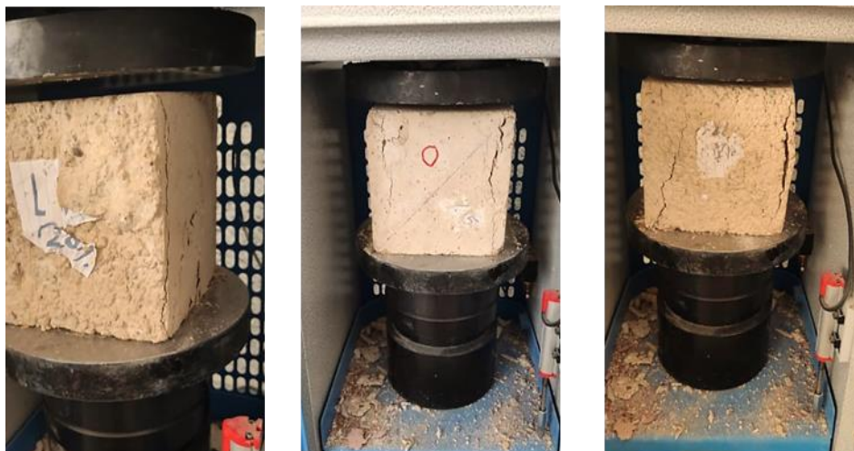
شکل ۱۲ آزمایش مقاومت فشاری نمونه‌های بتن رنگی پس از قرار گیری در چرخه انجماد و نمایش ترک‌های سطحی در پوسته
