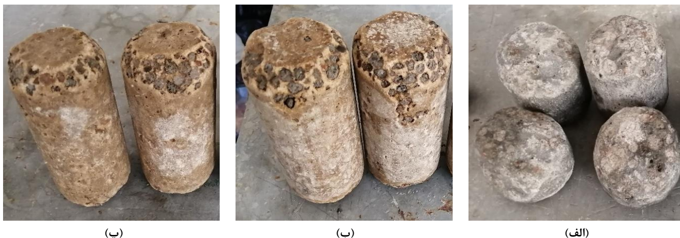
شکل ۳: نمونه‌ها پس از قرارگیری در دستگاه لس آنجلس شکل (الف) نمونه‌های بتن سبک، شکل (ب) نمونه‌های بتن پلیمری بدون الیاف و شکل (پ) نمونه‌های پلیمری حاوی الیاف
